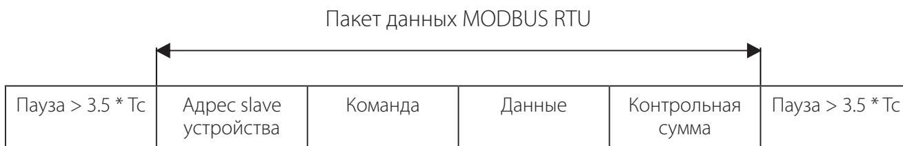
Рис 8-5 Структура пакета MODBUS RTU
